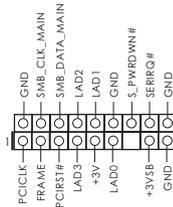
此接頭支援信賴平台模組 (TPM) 系統，可確保儲存金鑰、數位憑證、密碼及資料的安全。TPM 系統也能強化網路安全、保護數位身分並確定平台完整性。
